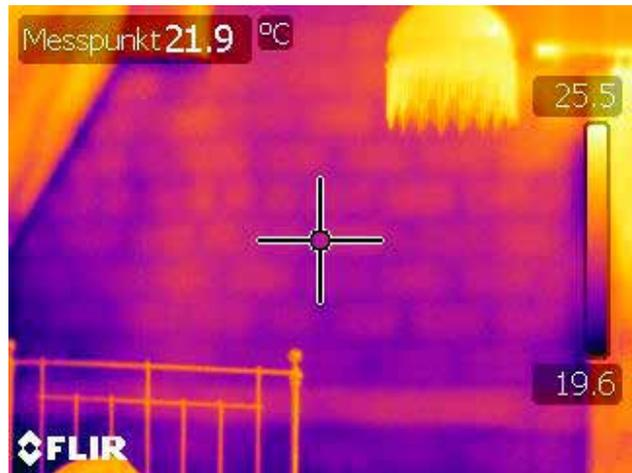
Thermografiebilder wurden bei den Untersuchungen nicht hinsichtlich der Wärmeabstrahlung eingesetzt, sondern um der Konstruktion der Außenhülle auf die Spur zu kommen.
